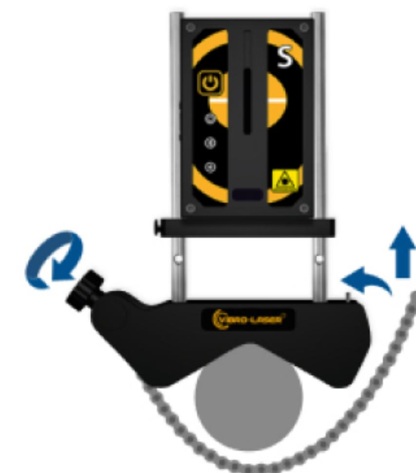
Для более точной настройки положения линии лазера воспользуйтесь колесом коррекции, расположенным на обратной стороне каждого из измерительных блоков.
