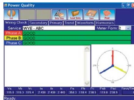
**Проверка подключения и фазировка кабелей**
