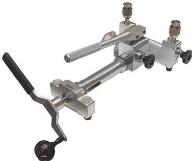
Пресс УСД-700В является вспомогательным оборудованием, применяемым для поверки и калибровки средств измерения давления методом сличения показаний эталонного и рабочего средств измерений. Пресс может использоваться как в полевых, так и в лабораторных условиях.
