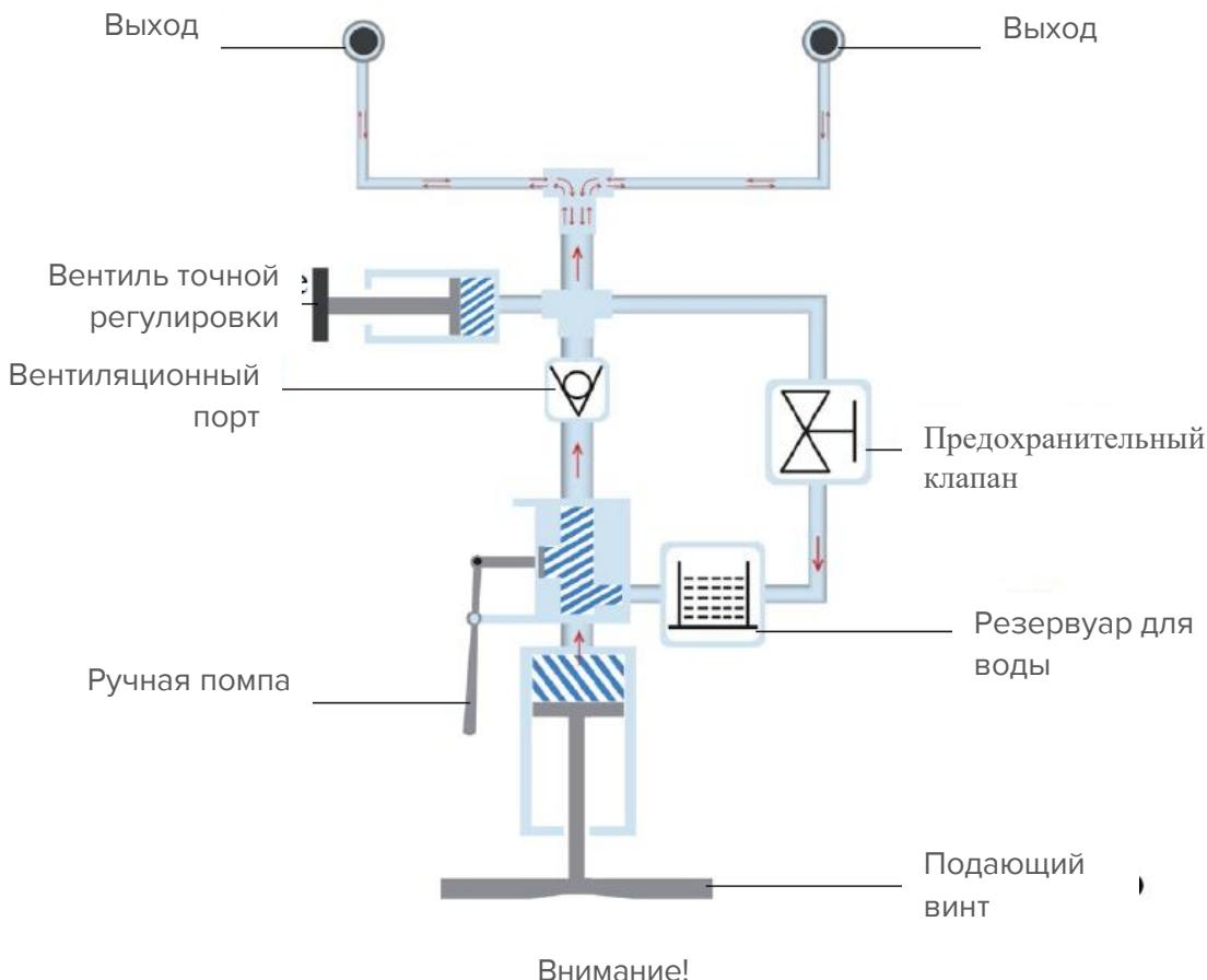
1. При снятии испытуемого манометра в системе не должно быть никакого остаточного давления.
